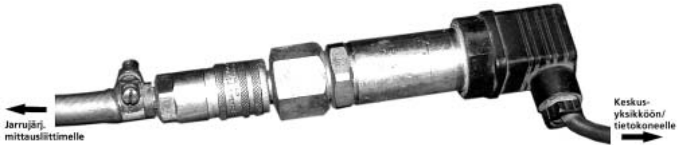
Kuvassa langallinen painelähetin.
